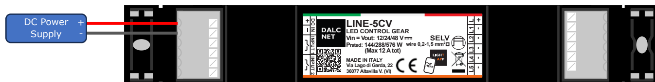
Figura 9: Schema di collegamento dell'Alimentazione
