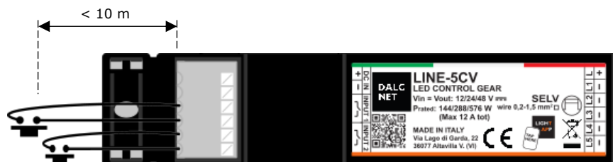
Figura 7: Collegamento del Comando Locale per brevi distanze
